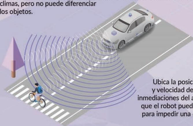
Ubica la posición y velocidad de las inmediaciones del auto para que el robot pueda frenar para impedir una colisión.
